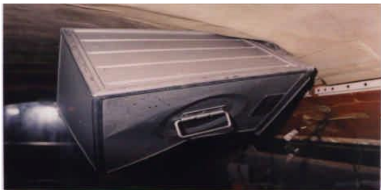
Εικόνα 2 Ρουμανικό Πόρισμα ατυχήματος, Σελίδα 77, φωτογραφία 3, η χαρακτηριστική φωτογραφία του ατυχήματος με το κουτί των σάντουιτς να έχει καρφωθεί στην οροφή του αεροσκάφους την οποία και είχε τρυπήσει, φανερώνοντας τη βιαιότητα των ταλαντώσεων που στοίχησε τη ζωή σε 7 ανθρώπους.
